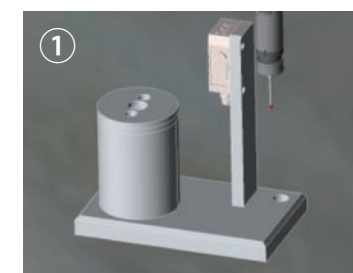
测头移动到测针清洁装置的传感器一侧。
