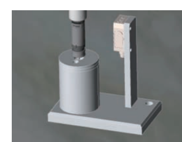
测头在清洁装置上上下下移动数次，通过清洗液和压缩空气来清洁测针。
